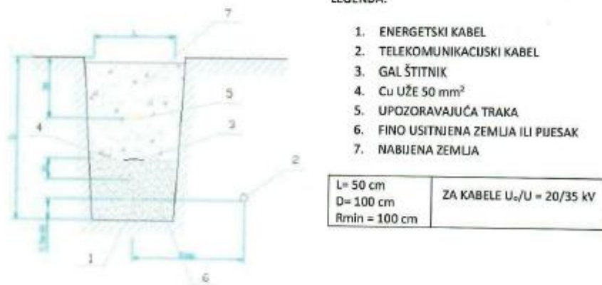
Slika 32. Detalji polaganja energetskog kabla u zelenoj površini
